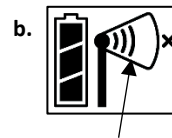
Sobald ein Netzwerk gefunden wurde, blinkt das Symbol nicht mehr, und die Balken erscheinen der Reihe nach von links nach rechts.
