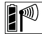
Nachdem der Knoten dem Netzwerk beigetreten ist, verschwindet das „x“-Symbol; die Zahl der Kanäle auf dem LCD-Display der Station nimmt um die Zahl der Messkanäle für den Knoten plus Batterie zu.
